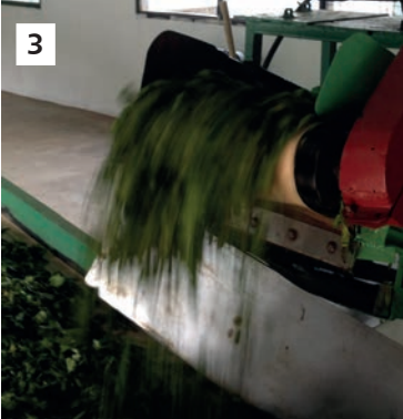
1. Sección de marchitado donde se almacenan las hojas verdes en contenedores galvanizados con base perforada. 2/3. Transportador inclinado con las hojas verdes procedentes del marchitado hacia la clasificación. 4. Clasificación de las hojas verdes en un transportador que equipa una Clina 21CK.
