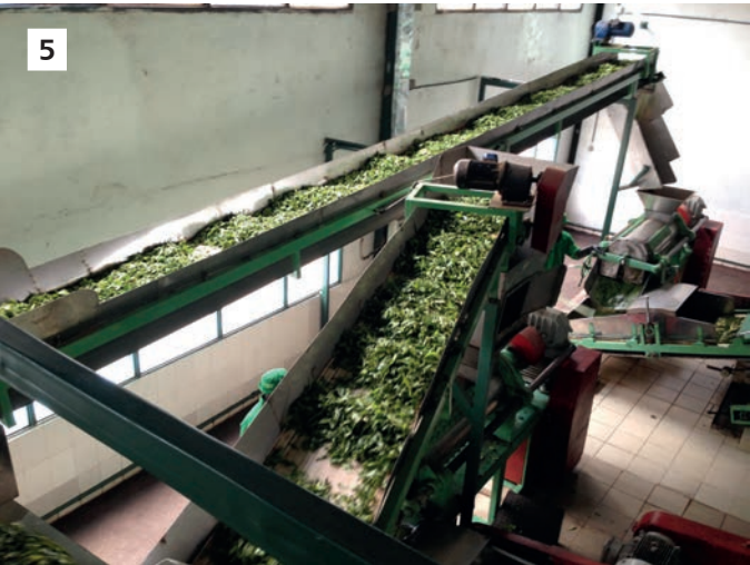
5. Transportador inclinado desde las líneas 1 y 2 hacia la fase C.T.C. ( Clina 12CF ).
