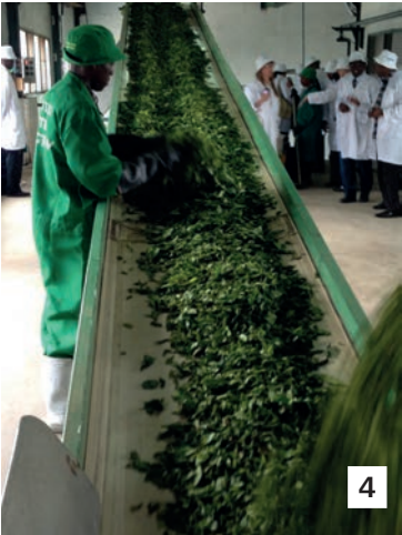
1. Sección de marchitado donde se almacenan las hojas verdes en contenedores galvanizados con base perforada. 2/3. Transportador inclinado con las hojas verdes procedentes del marchitado hacia la clasificación. 4. Clasificación de las hojas verdes en un transportador que equipa una Clina 21CK.
