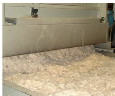
Salida de la lana una vez mezclada con aditivos blanqueadores.
