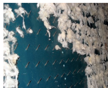
Detalle de la telera que recoge y abre la lana transportada por la acompañadora.
