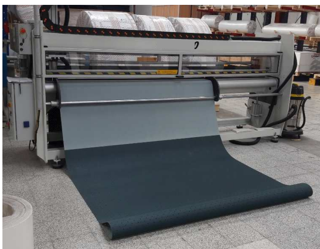
Banda colocada en la punzonadora lista para perforar.
