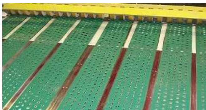
Banda perforada para la industria del cartón corrugado.
