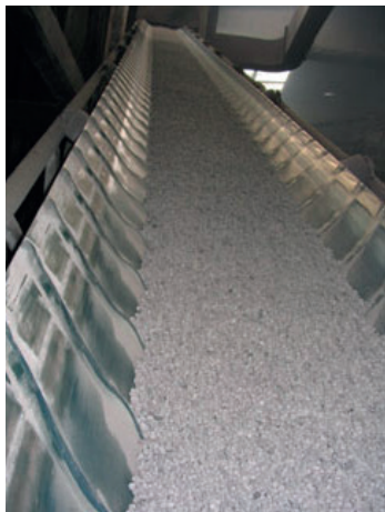
DRAGO 30 CC , transportando fertilizante en polvo, aditivado con aceites químicamente muy abrasivos.
