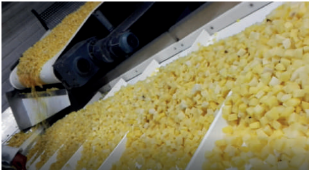
Bande CLINA S 20UFMT avec tasseaux transportant des pommes de terre.
