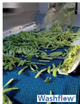
NX09 UA2MT-AM double revêtement PU et relief positif inférieur A2 « grain de riz ».
