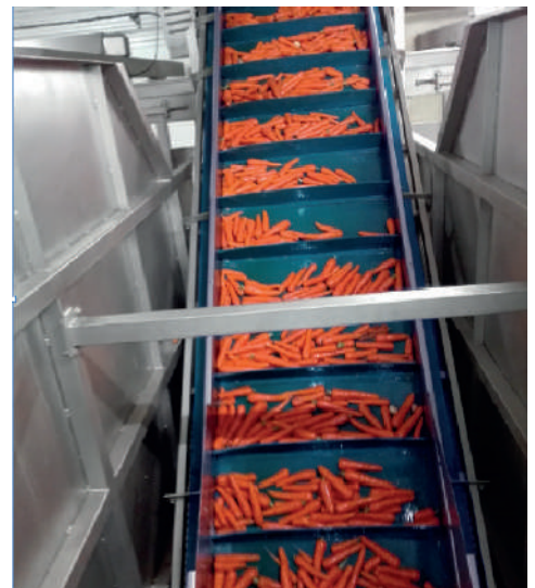
FEBOR 19CK avec tasseaux sur transport incliné de carottes.
