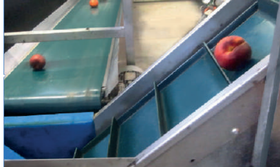
FEBOR 14CF GR EU avec tasseaux et profils longitudinaux "punkys".
