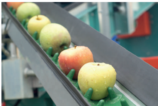
Profils spéciaux "tétos" sur bande dans moissonneuse de fruits à peau fine (pommes).
