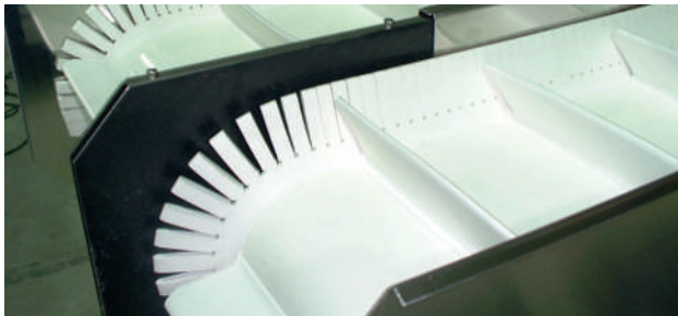
Bande blanche en PVC avec profils latéraux de contention « punkys ».
