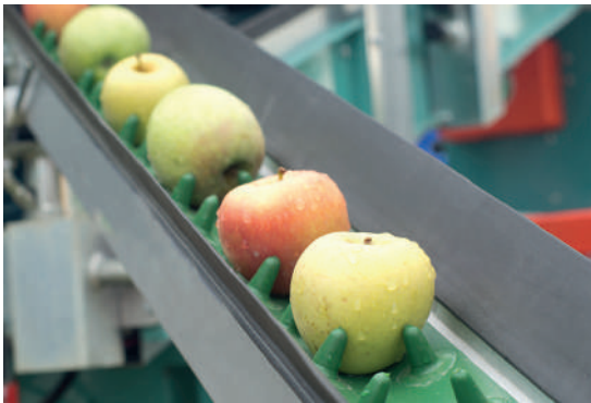
Perfiles especiales "tetones" sobre banda en cosechadora de frutas de piel fina (manzanas)..
