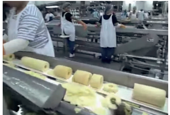
Transporte de piña cortada sobre banda ESPOT con cantos sellados.
