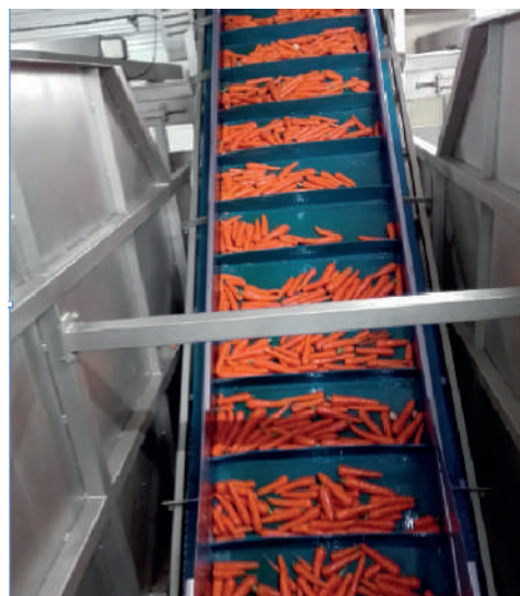
FEBOR 19CK con perfiles transversales en transporte inclinado de zanahorias.
