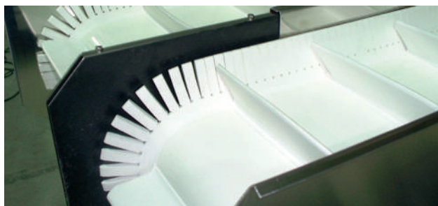
Banda blanca de PVC con perfiles laterales de contención "punkys".
