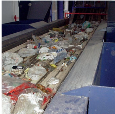
ESPOT 40CC dans une usine de recyclage transportant des résidus solides.
