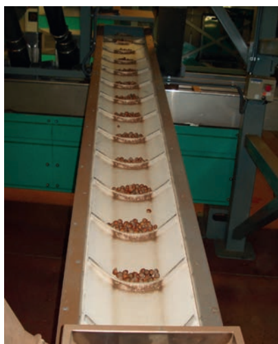
Transport en auge de noisettes.
