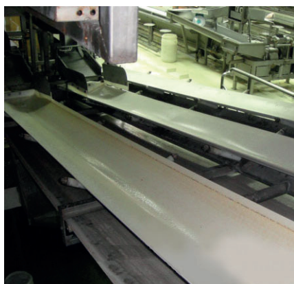
ESPOT 20CC Transport incliné dans le traitement d'ananas.
