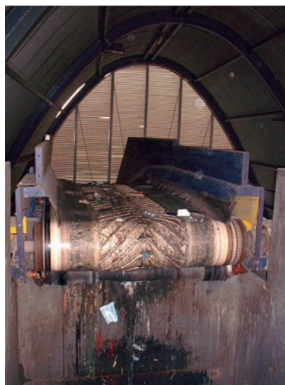
ESPOT 20CC avec profils X dans une usine de traitement des déchets.
