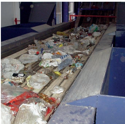
ESPOT 40CC en planta de reciclaje transportando residuos sólidos.
