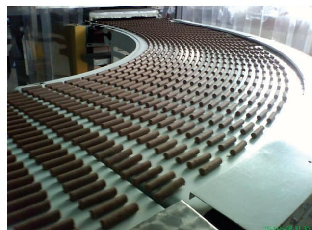
■ Las bandas **esbelt** permiten un control fiable del transporte de la paquetería en los transportadores curvos y espirales así como en tramos inclinados, ascendentes/descendentes. La posibilidad de obtener la banda curva de una sola pieza y realizar un único empalme, mejora su estabilidad dimensional asegurando una buena transferencia sin variar la orientación del producto.
