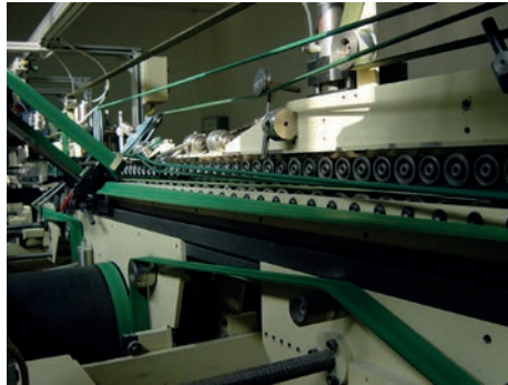
Courroie Toptrans EE10/3 dans plieuse de cartons de tabac.
