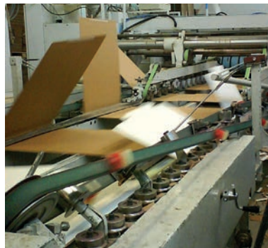
Flexo folder. Courroie EE 10/4. Revêtement relief Y.
